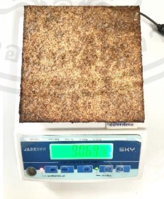
รูปที่ 3.38 ชั่งน้ำหนักตัวอย่างชิ้นทดสอบหลังจากครบ 28 วัน
