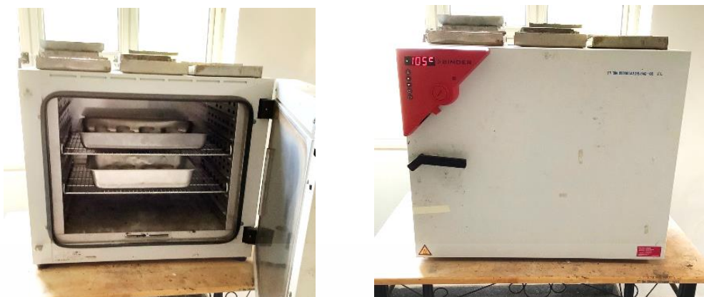
รูปที่ 3.35 อบชิ้นทดสอบที่อุณหภูมิ 105 องศาเซลเซียส
