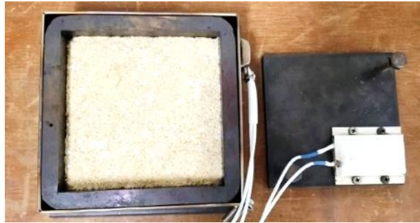
รูปที่ 3.30 ส่วนผสมใส่ลงในบล็อกเหล็กกล้าอัดขึ้นรูปจนวนกันความร้อน
