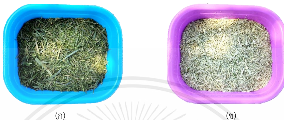
รูปที่ 3.21 ลักษณะของ (ก) เส้นใยใบปาล์ม และ (ข) เส้นใยทางปาล์ม ผ่านกระบวนการบดละเอียดด้วยเครื่องบดละเอียดมอเตอร์ขนาด 5 แรงม้า
