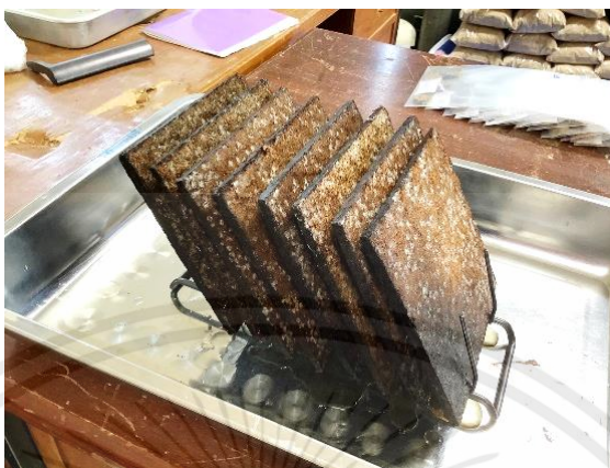
รูปที่ 3.41 ตั้งพักขึ้นทดสอบในลักษณะ 45 องศา เป็นระยะเวลา 10 นาที
