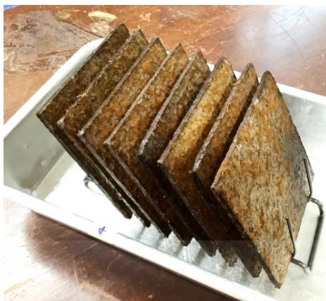
รูปที่ 3.43 ตั้งพักขึ้นทดสอบในลักษณะ 45 องศา อุณหภูมิห้องเป็นระยะเวลา 5 นาที
