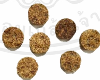
รูปที่ 3.44 ตัวอย่างขึ้นทดสอบขนาดเส้นผ่านศูนย์กลางหน้าตัดกว้าง 25 มิลลิเมตร
