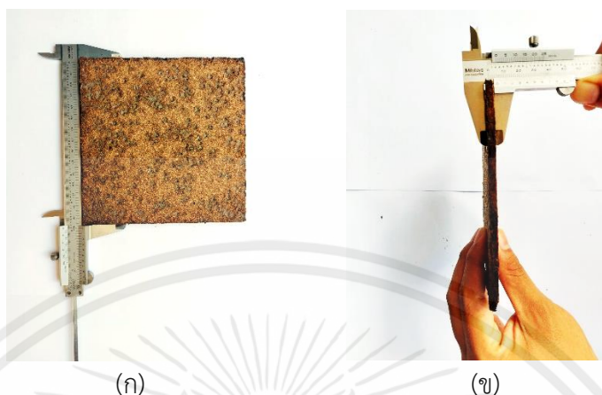
รูปที่ 3.39 วัดระยะขนาด (ก) วัดขนาดความกว้าง และความยาว (ข) วัดขนาดความหนา
