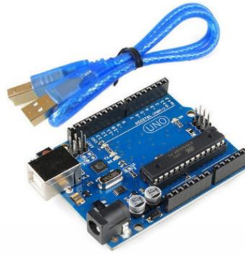
รูปที่ 3.9 บอร์ด Arduino รุ่น Uno R3
