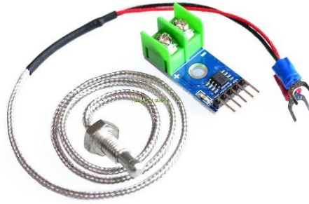
รูปที่ 3.6 เซนเซอร์วัดอุณหภูมิ type K
