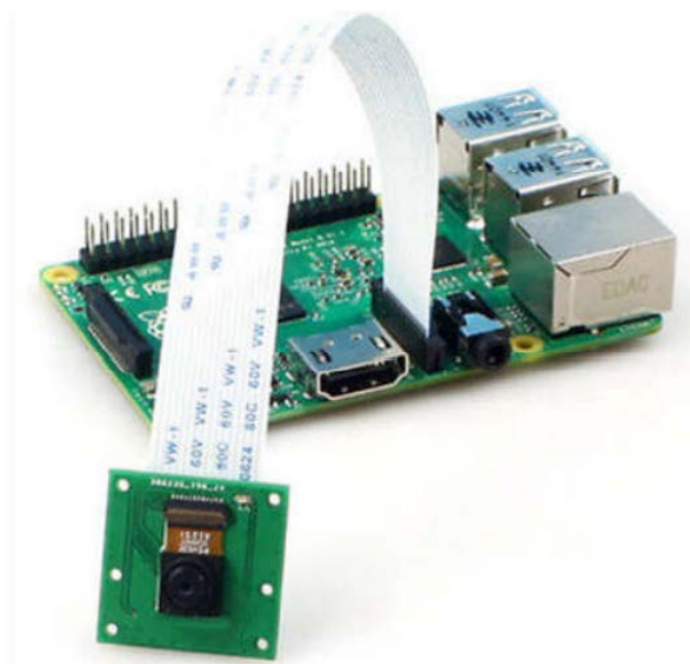
รูปที่ 2.3 แสดงเชื่อมต่อโมดูลกล้องกับบอร์ดราสเบอร์รี่ พาย ผ่านพอร์ต CSI
