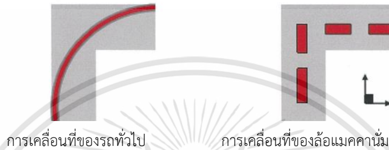
รูปที่ 3.4 ทิศทางการเคลื่อนที่ของล้อแมคคานัม
