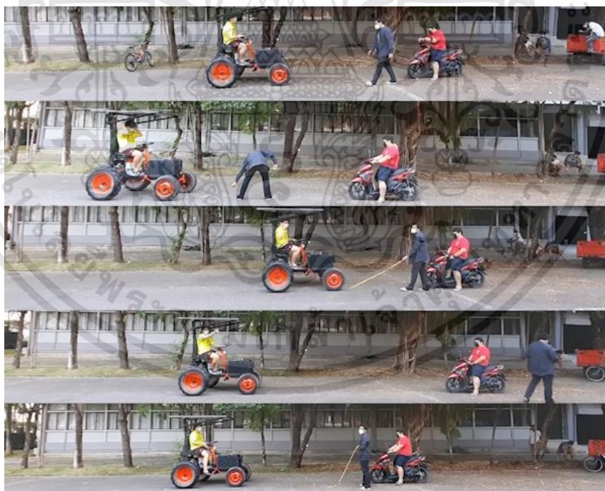
รูปที่ 4.4.4 ทดสอบโดยนำรถจักรยานยนต์มาขวางหน้ารถ
