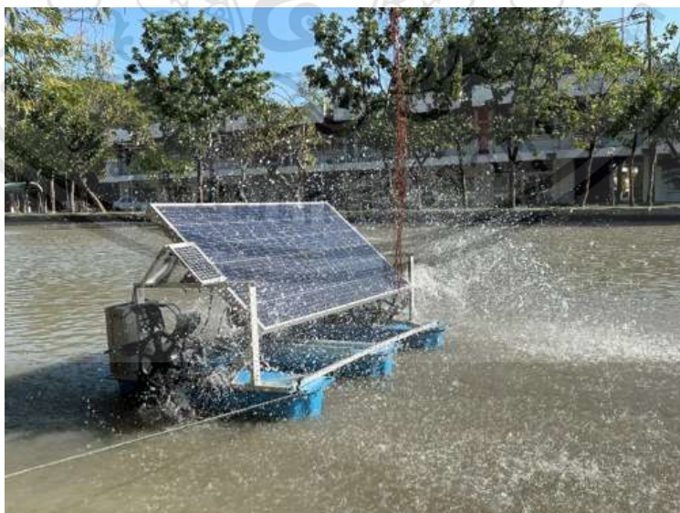
รูปที่ 3.8 ทดลองและเก็บผลการทดลองของแอปพลิเคชัน Blynk และ โซลาร์เซลล์หมุนตามตะวัน
