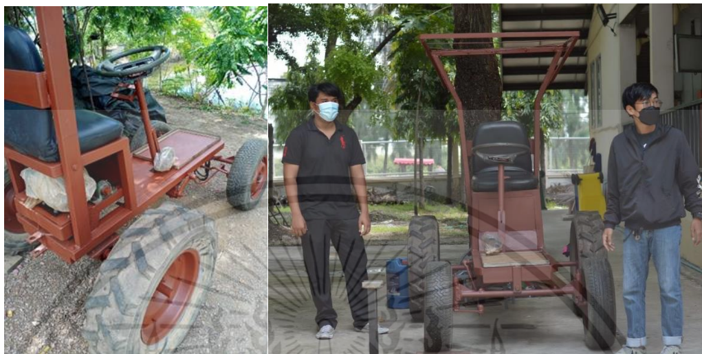
รูปที่ 3.8 โครงสร้างที่พร้อมติดตั้งอุปกรณ์ควบคุม
