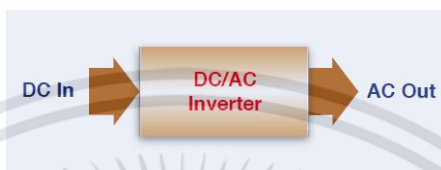
รูปที่ 2.6 การทำงานของอินเวอร์เตอร์(Inverter)
