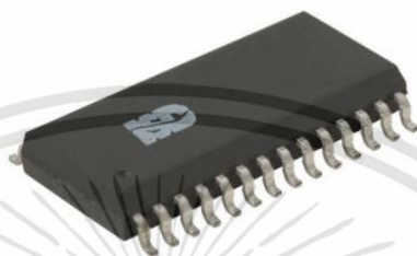
รูปที่ 2.10 โครงสร้างแบบ SOIC
