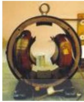
รูปที่ 2.27 ส่วนที่อยู่กับที่หรือสเตเตอร์
