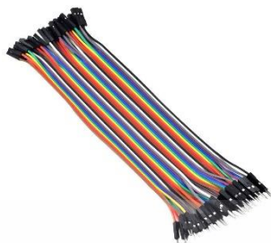
รูปที่ 2.16 สายไฟจัมเปอร์
