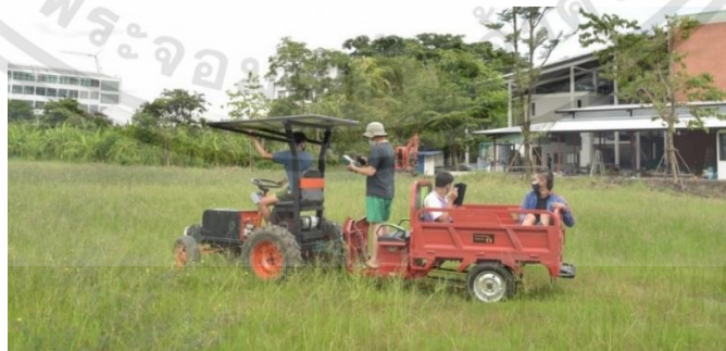
รูปที่ 4.2 รถไถไฟฟ้าโดยมีการต่อภาระโหลด
