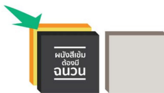
ภาพที่ 7.5 ภาพแสดงการแก้ปัญหาความร้อนจากสีของผนังที่ภายนอก
