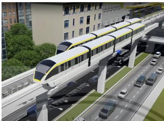
ภาพที่ 6.15 แสดงรถไฟฟ้าสายสีเหลืองระบบรถไฟฟ้าทางเดี่ยว
