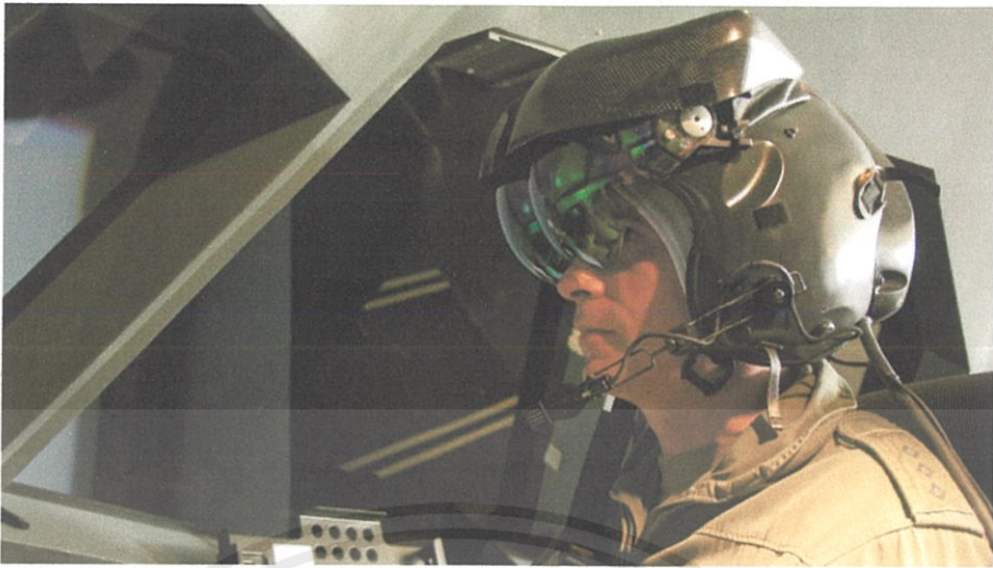
รูป 2.2 ตัวอย่าง“จอแสดงผลภาพติดศีรษะ”หรือ “head-mounted display(HMD)”
