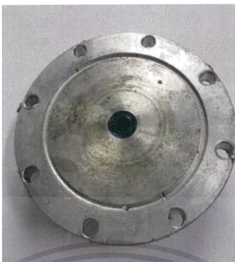
รูปที่ 4.9ข. ส่วนเสริมก้านสูบ(ขยายรูตรงกลางเพื่อใส่ยูคัพ)
