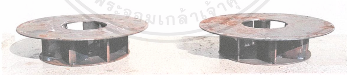
รูปที่ 3.7 แผ่นสร้างกระแสอากาศหมุนควงที่อัตราการหมุนควงเท่ากับ ก.) 0.8 และ ข.) 0.3
