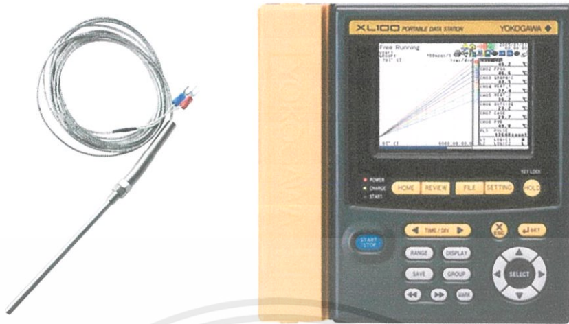
รูปที่ 3.9 เทอร์โมคัปเปิลชนิดเค และหน่วยแสดงผล YOKOGAWA XL100
