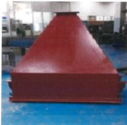
รูปที่ 3.15 แสดงลักษณะฮอปเปอร์จากการออกแบบ [1]
