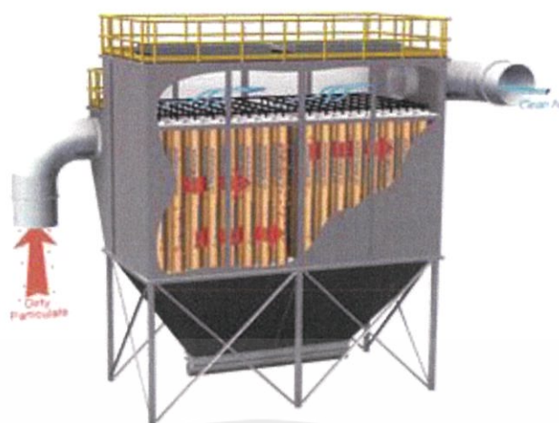
รูปที่ 2.11 แสดงลักษณะเครื่องดักฝุ่นด้วยผ้ากรอง ( http://www2.donaldson.com/tetratex/ , (2017))
