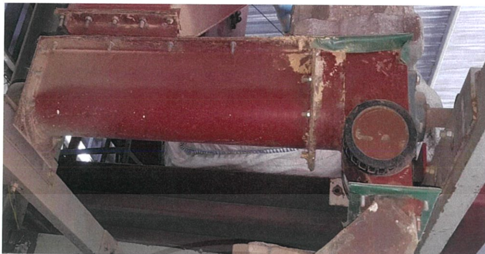
รูปที่ ข.4 แสดงสกรูพืดสำหรับลำเลียงเชื้อเพลิงอัดเม็ด (Screwfeed to Hammermill)
