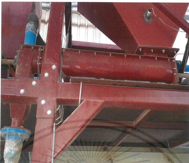
รูปที่ ข.10 แสดงลักษณะสกรูพืดลำเลียงเชื้อเพลิงชีวมวลผง (Screwfeed to Pre Chamber)
