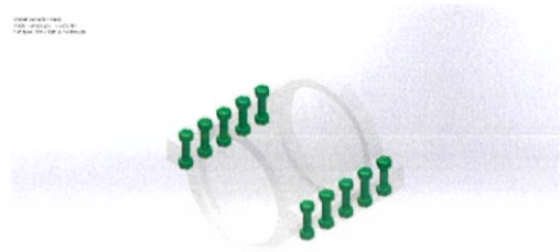
รูปที่ 5.6 แรงแนวแกน (Axial Force) บนสลัก เกลียว
