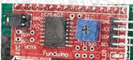
รูปที่ 3.14 อุปกรณ์ควบคุมการเชื่อมต่อหน้าจอกับ Arduino
