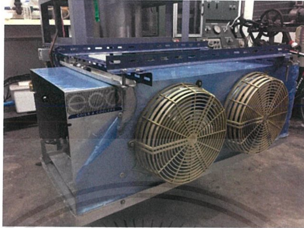
รูปที่4.5 Evaporator
