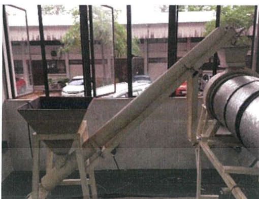
รูปที่ 4.9 ชุดสกรูขนถ่ายวัสดุและกรวยป้อนวัสดุ
