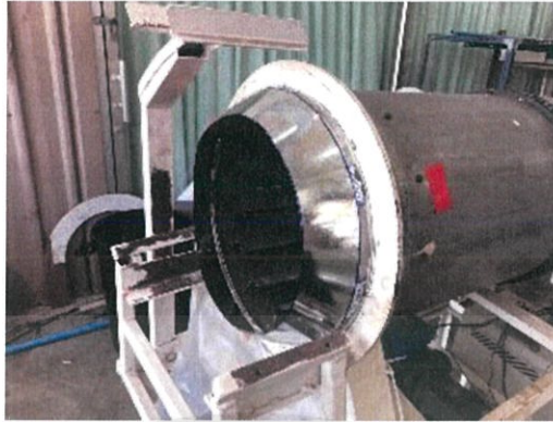
รูปที่ 4.24 ถังเตาอบด้านปลายหลังทำการติดชิ้นงานฝาปิดด้านปลาย
