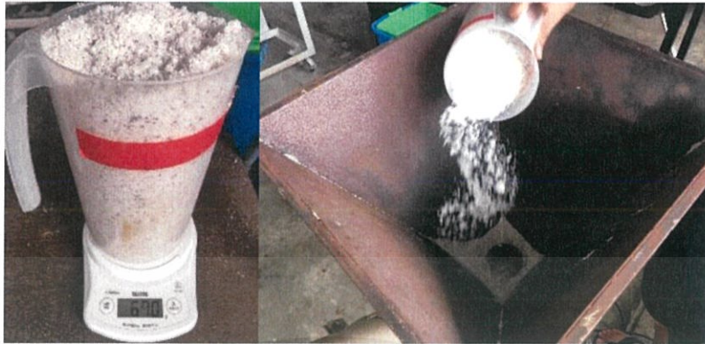
รูปที่ 4.37 การป้อนมะพร้าวด้วยอัตราป้อน 0.5 กิโลกรัม ต่อนาที
