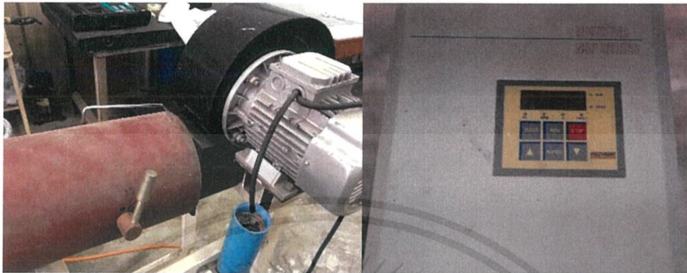
รูปที่ 4.32 ตัวปรับความเร็วลม (Damper) และ อินเวอร์เตอร์
