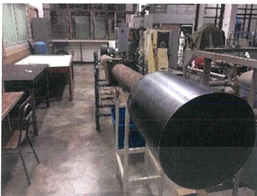
รูปที่ 4.18 ท่อลมหลังจากติดตั้งส่วนต่อขยายท่อลม
