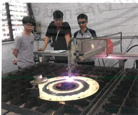
รูปที่ 4.20 ตัดฝาปิดด้วยการตัดแบบCNC Plasma Machine
