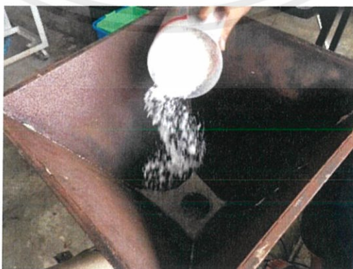
รูปที่ 4.31 การป้อนกากมะพร้าวเข้าสู่ชุดสกรูขนถ่ายวัสดุและกรวยป้อนวัสดุ
