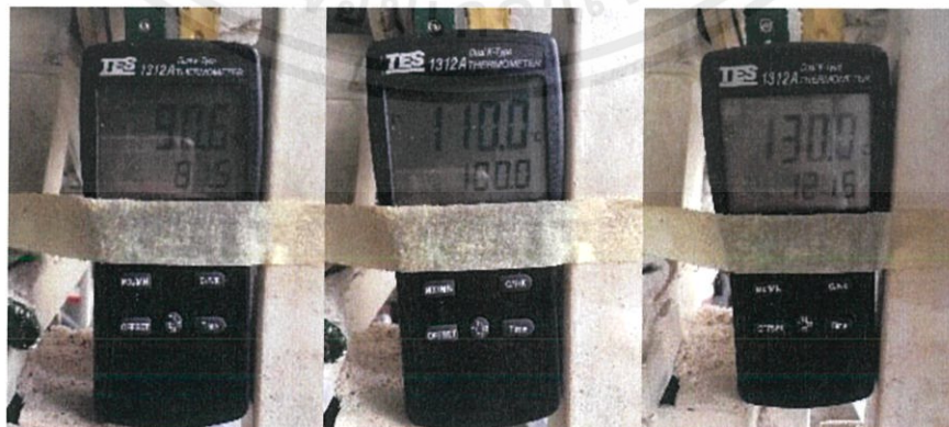
รูปที่ 4.36 อุณหภูมิลมร้อนที่ 90, 110 และ 130 องศาเซลเซียส
