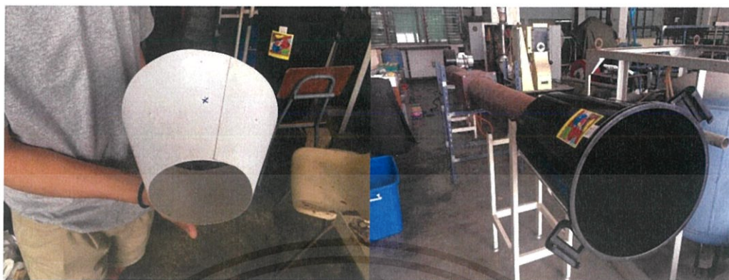
รูปที่ 4.15 แบบจำลองกรวยดักกลม และส่วนต่อขยายท่อลม
