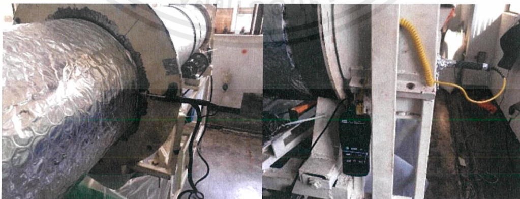
รูปที่ 4.26 การติดตั้ง Thermocouple ที่ทางเข้าและทางออกของถังเตาอบ
