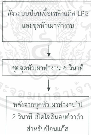
รูปที่ 4.18 แสดงวงจรการทำงานระบบป้อนเชื้อเพลิงแก๊ส LPG และจุดหัวเผา
