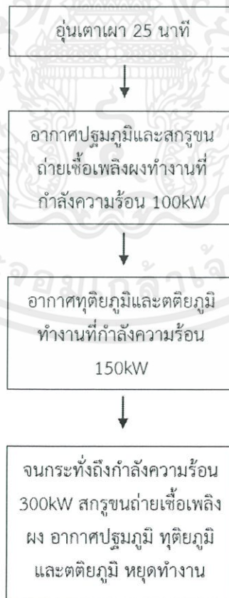
รูปที่ 4.25 แสดงวงจรการทำงานระบบป้อนอากาศเข้าสู่ห้องเผาไหม้
