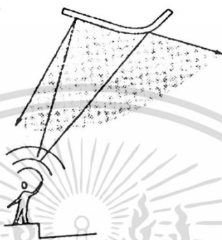
ภาพที่ 2-50 การติดตั้งวัสดุช่วยในการสะท้อนเสียงของแผ่นโค้งนูน (ที่มา : Building for the Performing Arts. 1996)
