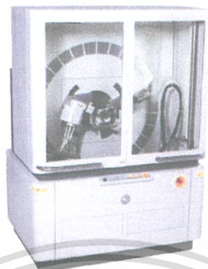
รูปที่ 2.11 เครื่องวิเคราะห์การเลี้ยวเบนรังสีเอกซ์ [20]
