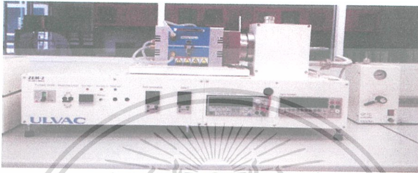
รูปที่ 2.25 เครื่องวัดค่าสภาพต้านทานไฟฟ้าและสัมประสิทธิ์ซีเบค หรือ ZEM-3
