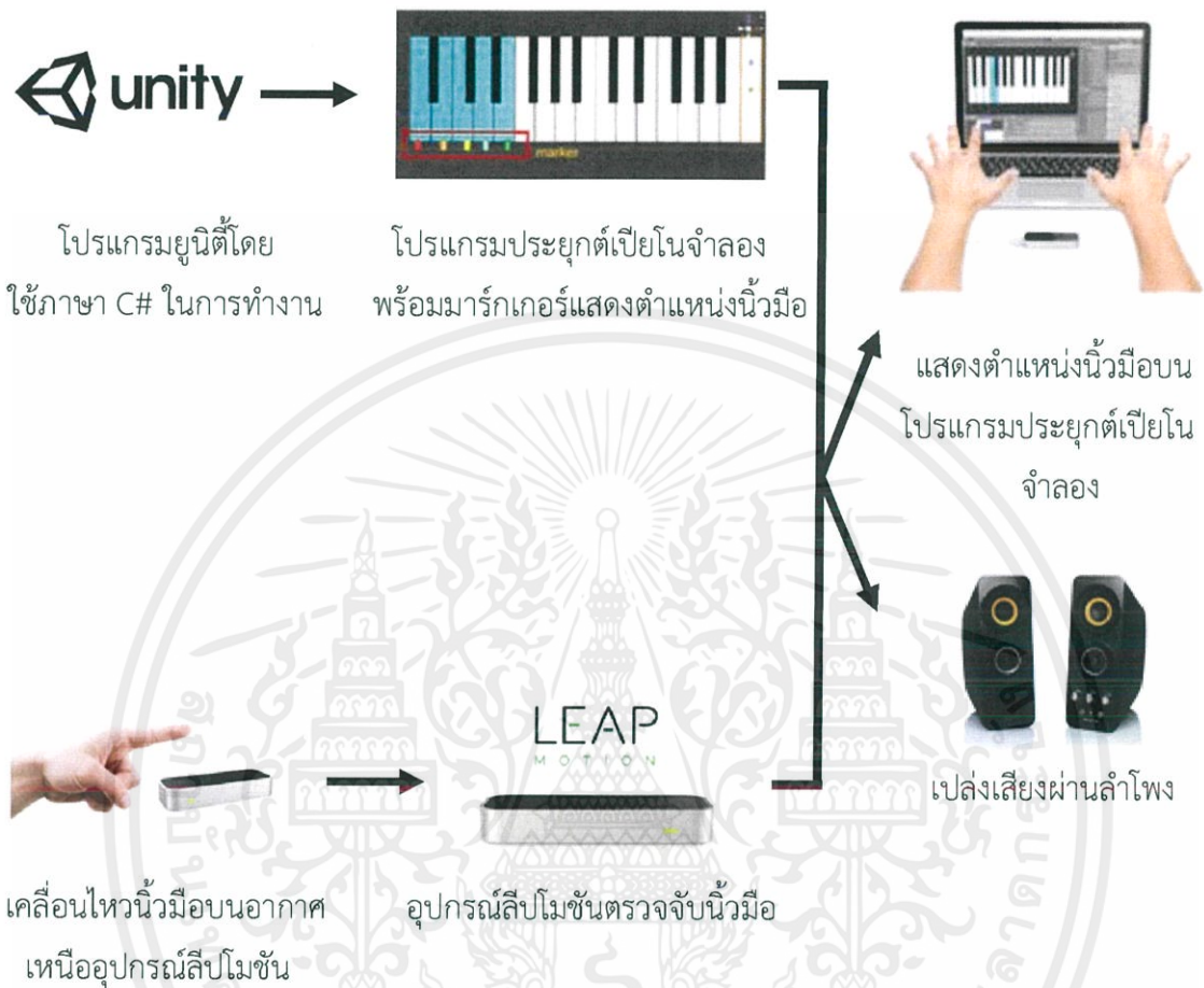
รูปที่ 1.1 บล็อกไดอะแกรมภาพรวมของปริญญานิพนธ์
