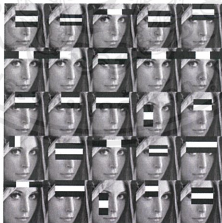
รูปที่ 2.15 ตัวอย่างตัวกรองอื่น ๆ ใน Viola-Jones Cascade[7]
