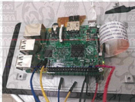
รูปที่ 4.8 การต่อ Raspberry Pi กับ Touchscreen LCD Display
