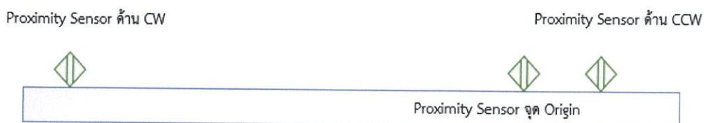
รูปที่ 3.4 แสดงการติดตั้ง Proximity Sensor ในตำแหน่งต่าง ๆ ภายในแบบจำลอง
