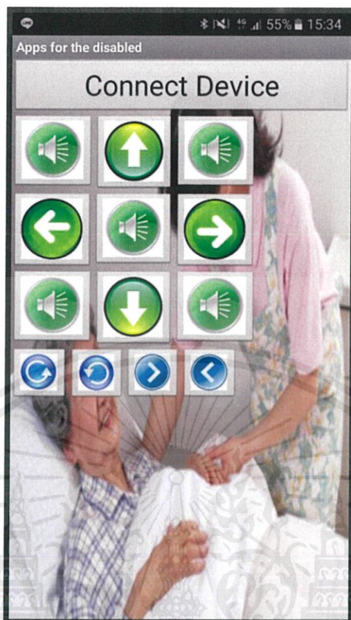
รูปที่ 3.11 หน้าจอแอปพลิเคชันที่ไฟล์ main.xml ที่อยู่ในส่วนของ res > layout
