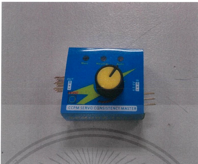
รูปที่ 3.3 Servo Servo Tester รุ่น CCPM Servo Consistency Master
