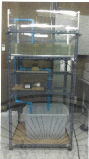
รูปที่ 4.12 การทดสอบประสิทธิภาพกังหันน้ำแบบ Curve
