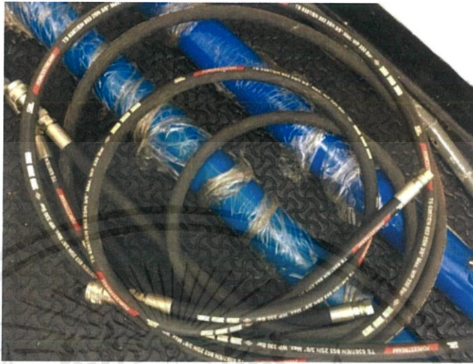
รูปที่ 3.4 สายน้ำมันไฮดรอลิก
