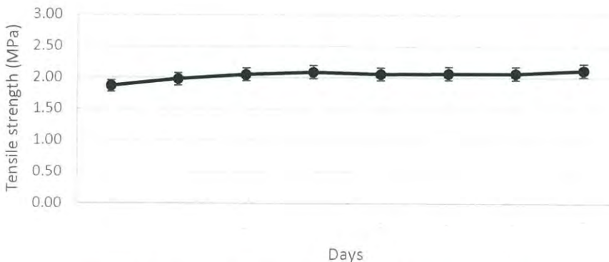
รูปที่ 4.20 ค่าความแข็งแรงดึงของตัวอย่างน้ำซีเมนต์โดนความร้อน
