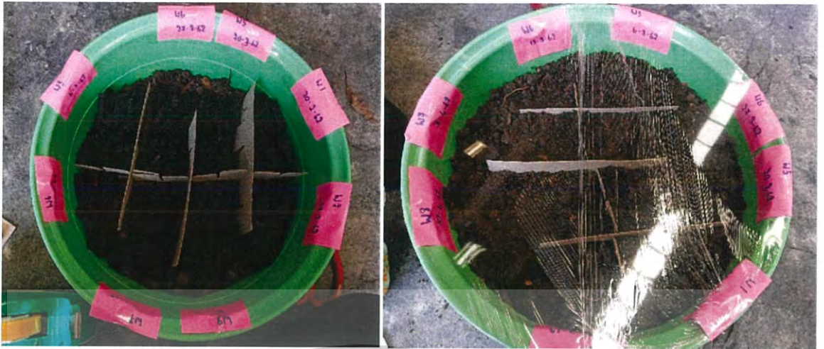
รูปที่ 3.1 การทดสอบการเสื่อมสภาพของตัวอย่างน้ำซึมนในดินแห้ง
