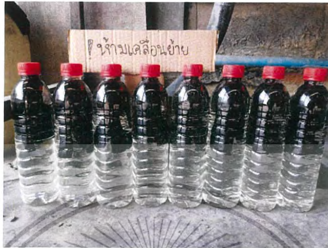
รูปที่ 3.3 การทดสอบการเสื่อมสภาพของตัวอย่างน้ำขุ่นในน้ำ
