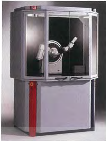
รูปที่ 3.4 เครื่องทดสอบการเลี้ยวเบนของรังสีเอ็กซ์ [30]
