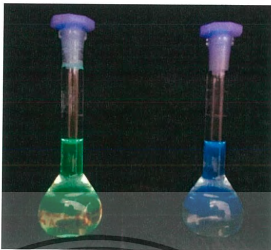
รูปที่ 4.7 การเรืองแสงของสารผลิตภัณฑ์ P-PTZ (ซ้าย) และ F-PTZ (ขวา)
