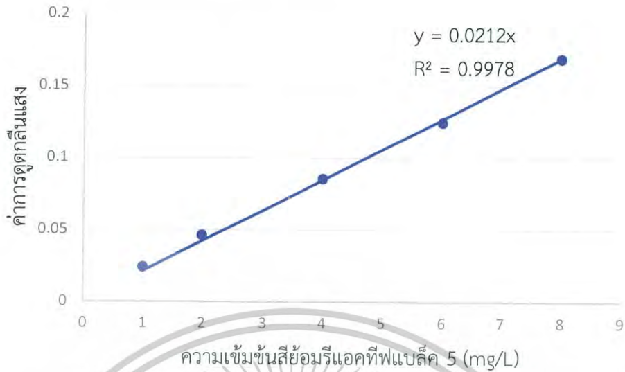
รูปที่ 4.13 กราฟมาตรฐานระหว่างค่าการดูดกลืนแสงกับความเข้มข้นสีย้อมรีแอคทีฟแบล็ค 5
