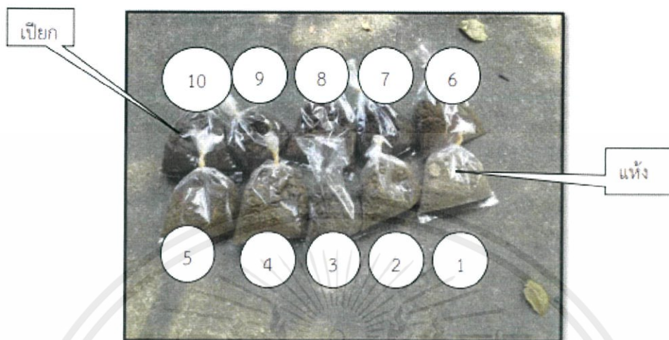
รูปที่ 3.6 ดินค่าความชื้น 10 ระดับจากแห้งไปยังเปี้ยก
