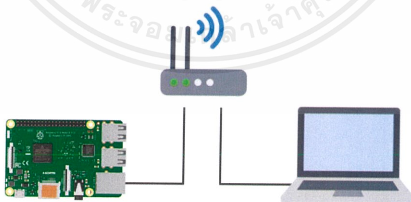
รูปที่ 3.2 การเชื่อมต่อ Raspberry pi กับ คอมพิวเตอร์
