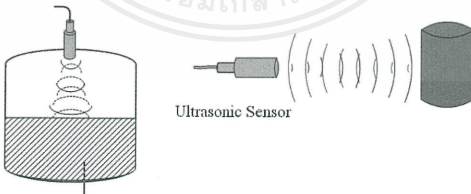
รูปที่ 2.2 การใช้คลื่นอัลตราโซนิกวัดระยะ
