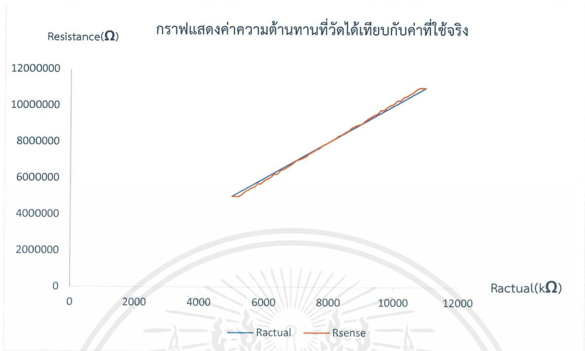
รูปที่ 4.16 ผลการแปลงค่าเฉลี่ยของสัญญาณดิจิตอลกลับไปเป็นค่าความต้านทาน
