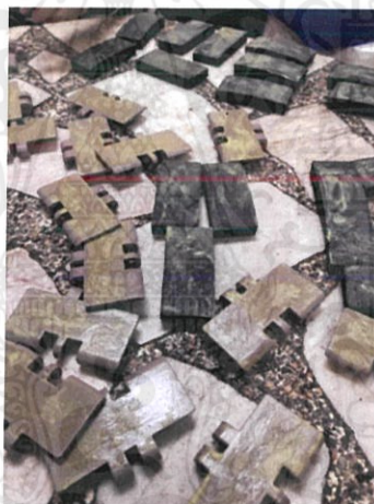
รูปที่ 3.6 นำแผ่นยางมาติดกับ Table top chain เพื่อเพิ่มแรงเสียดทาน
