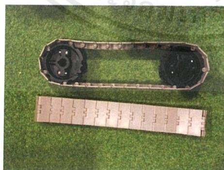
รูปที่ 3.7 นำTable top chain มาประกอบเข้ากับ Sprocket
