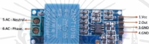
รูปที่ 2.2 ZMPT101B เซ็นเซอร์วัดปริมาณแรงดันไฟฟ้า
