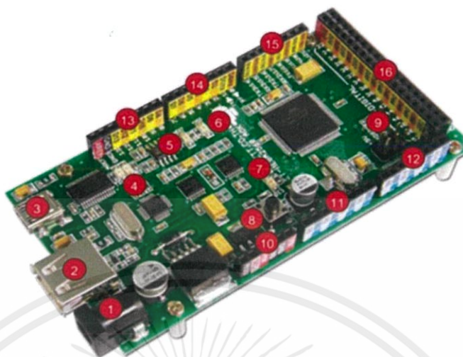
รูปที่ 2.8 โครงสร้างของบอร์ด Atmega2560
