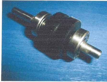
รูปที่ 2.20 ลักษณะของแกนโรเตอร์แบบแม่เหล็กถาวรมีซี่ (Teeth)
