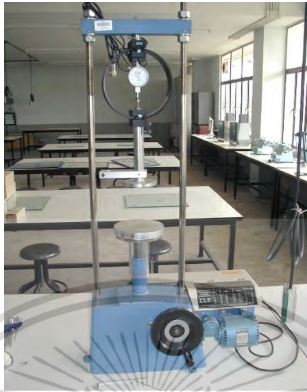
ภาพที่ 3.13 เครื่องทดสอบ Unconfined Compression Test
