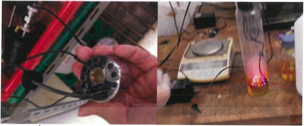
รูปที่ 3.4 อะตอมไมเซอร์(เครื่องทำหมอก) ทดสอบการทำหมอก
