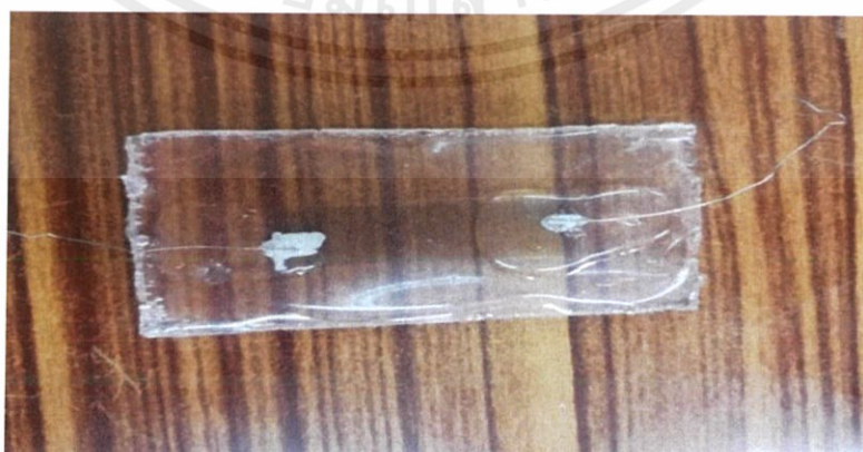
รูปที่ 4.7 เซ็นเซอร์ที่ทดสอบความโปร่งแสง
