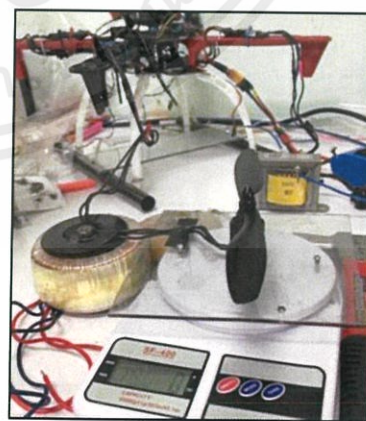
รูปที่ 3.13 การวัดแรงยกของมอเตอร์แต่ละตัว
