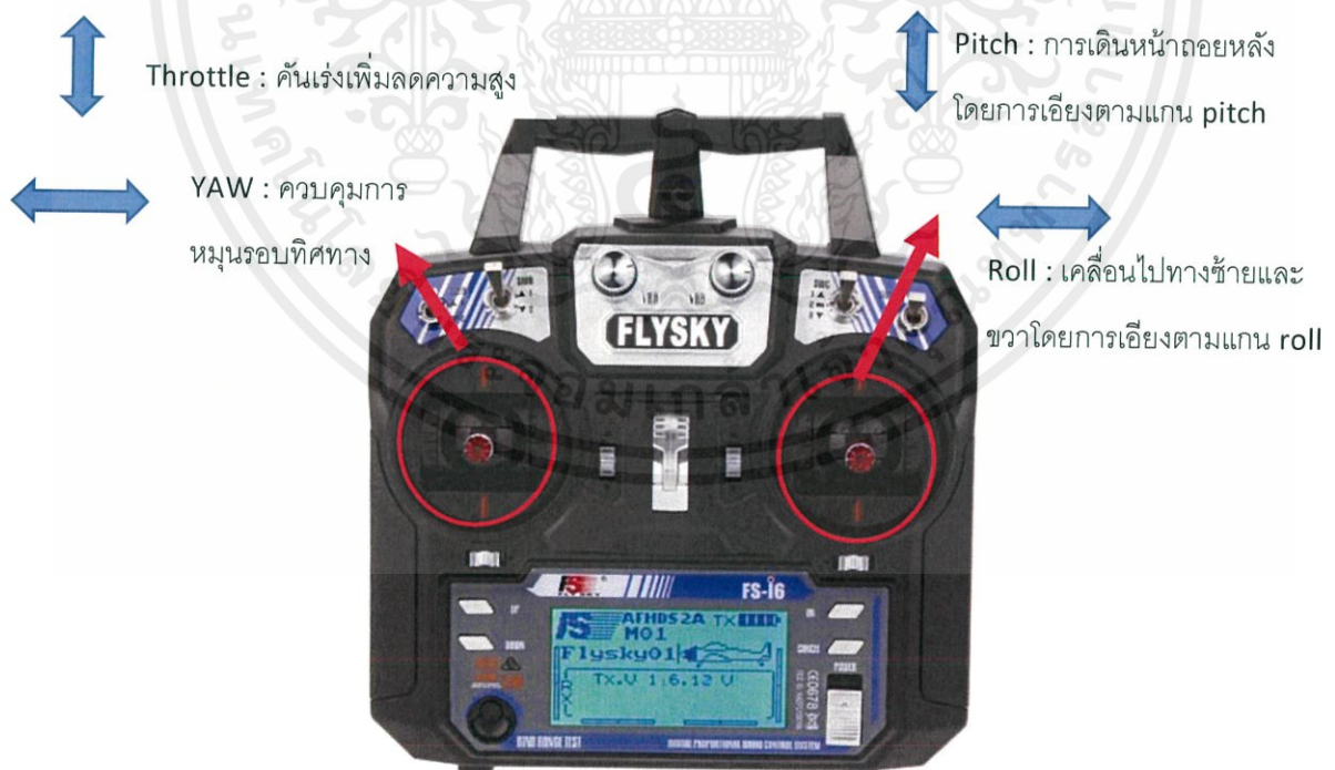
รูปที่ 3.8 รีโมทวิทยุ Flysky รุ่น FS - i6A
