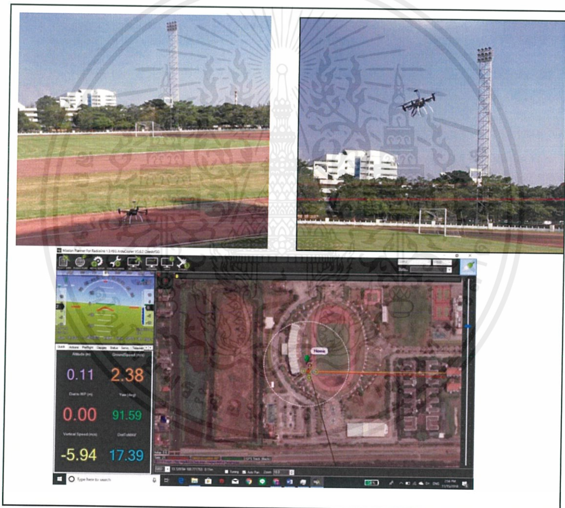
รูปที่ 4.1 การทดลองบินวัดกระแสและแรงดันพร้อมแสดงหน้าต่าง Mission Planner ขณะใช้งาน
