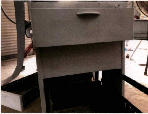
ภาพที่18-19 นำมาประกอบใหม่และเชื่อมติดกัน โดยนำส่วนที่ตัดมาเชื่อมปิดส่วนที่ขาดหายให้เกิดความเรียบร้อย แล้วขัดแต่งผิวที่เสียหาย และท้นสีรองพื้น
