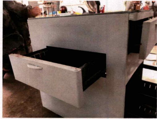
ภาพที่18-19 นำมาประกอบใหม่และเชื่อมติดกัน โดยนำส่วนที่ตัดมาเชื่อมปิดส่วนที่ขาดหายให้เกิดความเรียบร้อย แล้วขัดแต่งผิวที่เสียหาย และท้นสีรองพื้น
