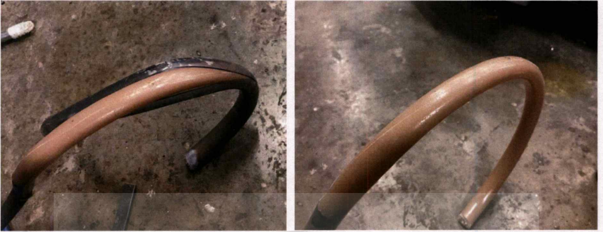
ภาพที่46-47 เมื่อเรซินแข็งตัวก็กรีดสายขางออก และนำไปขัดทำสี
