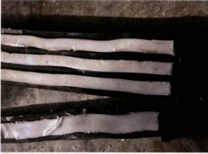
ภาพที่32-33 เมื่อชลิโคนแห้งจึงดึงออกจากพิมพ์แล้ว แล้วใช้กรรไกรตัดให้ได้ขนาดและนำไปล้างทำความสะอาดก่อนจะไปติดที่ตัวโทรศัพท์
