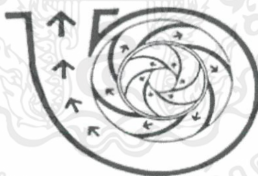
รูปที่ 2.22 แสดงปั๊มแรงเหวี่ยงหนีศูนย์กลางแบบ Diffuser (ที่มา : ienergyguru, (2558), ปั๊ม(Pump))
