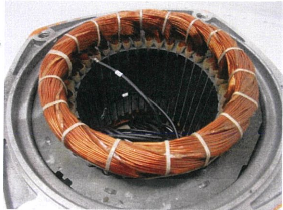
รูปที่ 2.4 โครงสร้างสเตเตอร์มอเตอร์เหนี่ยวนำสามเฟส
