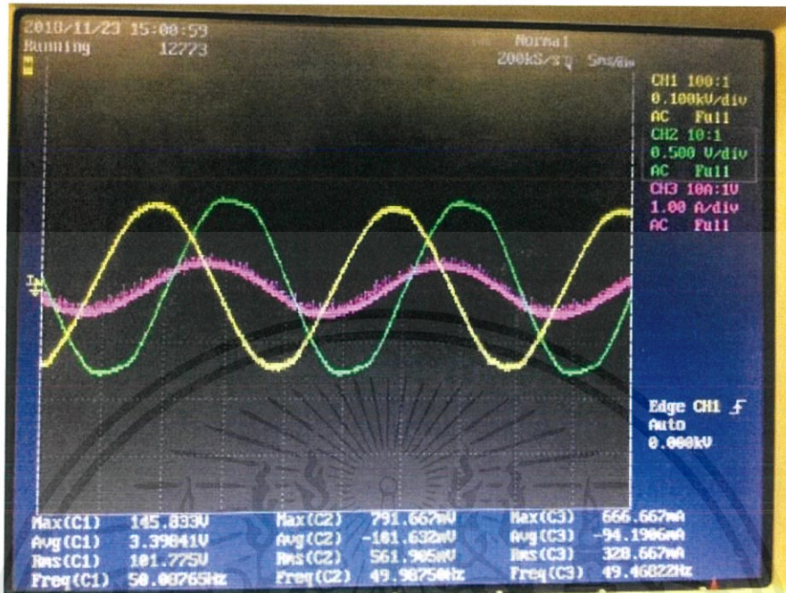
รูปที่ 4.7 สัญญาณจาก oscilloscope ที่มุม 60 องศา
