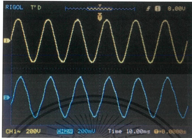
รูปที่ 4.27 กราฟแรงดันและกระแสของเฟส a ภาระโหลด 100%
