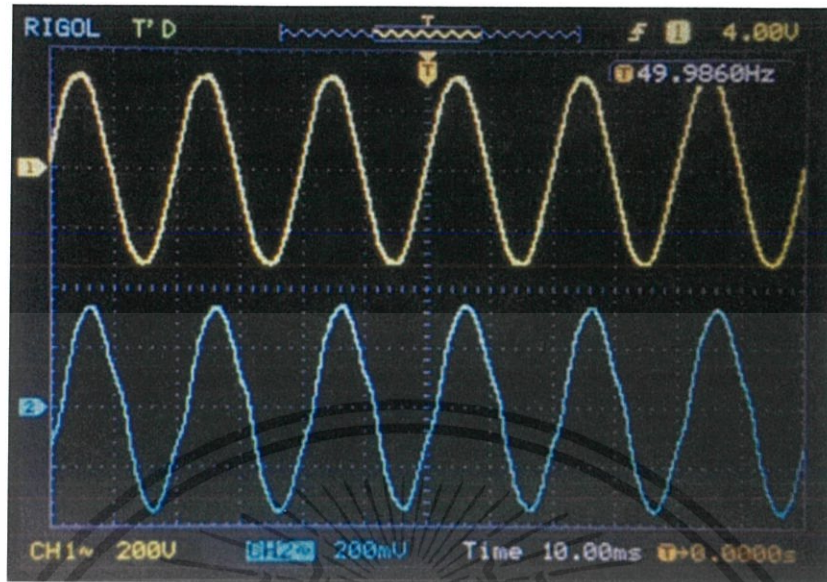
รูปที่ 4.31 กราฟแรงดันและกระแสของเฟส b กรณีโหลดมากกว่า 100%
