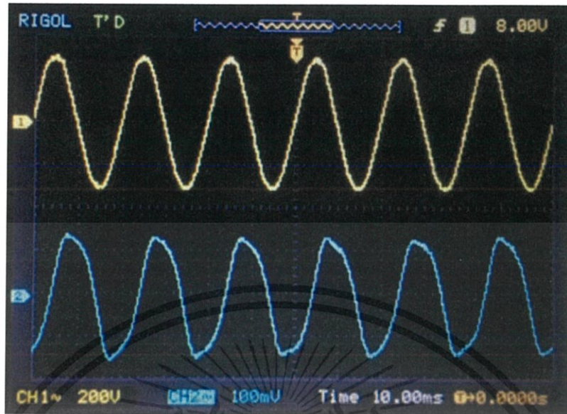
รูปที่ 4.21 กราฟแรงดันและกระแสของเฟส a กรณีโหลด 0%
