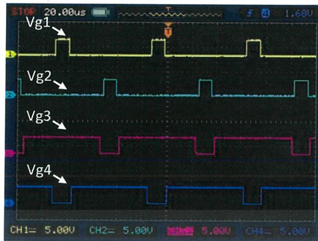
รูปที่ 4.10 สัญญาณ PWM ที่ใช้ขับอินเวอร์เตอร์
