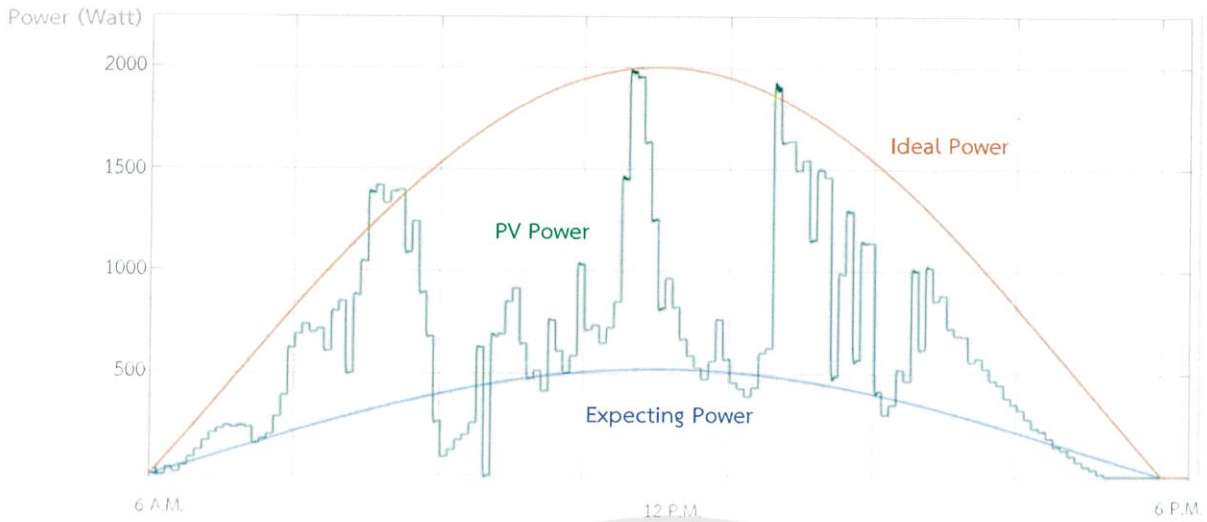
รูปที่ 4.16 โพรไฟล์กำลังไฟฟ้าของพลังงานแสงอาทิตย์ที่ใช้ในการทดลอง
