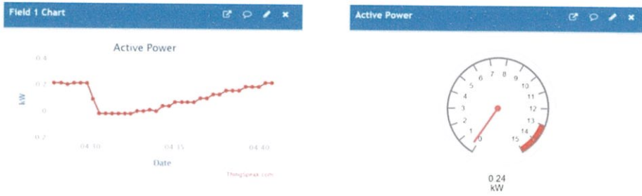
รูปที่ 4.5 การแสดงผลค่ากำลังไฟฟ้าจริงของเครื่องกำเนิดไฟฟ้า
